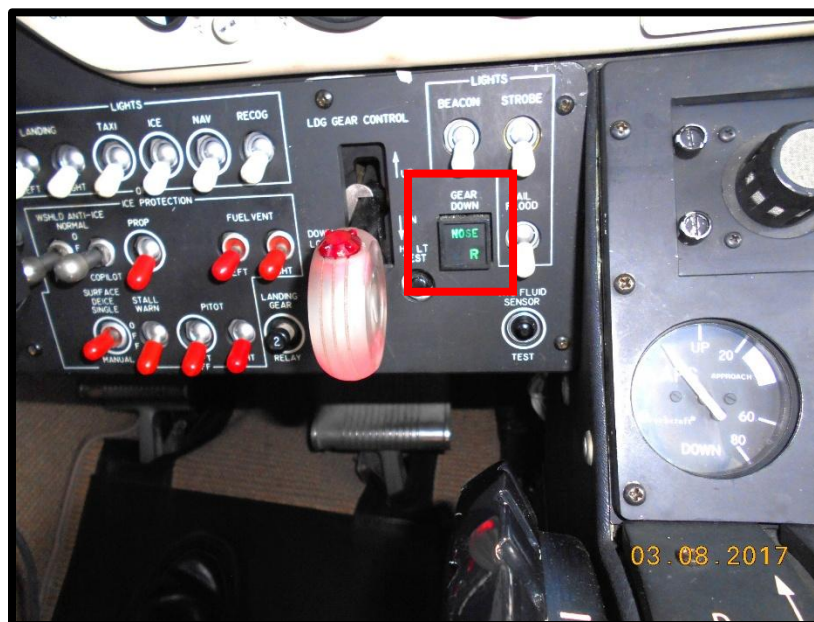
Fotografía No. 8 Vistas de las luces indicadoras de tren abajo y asegurado. Luz verde "L" apagada.
