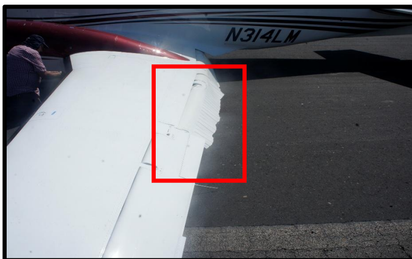
Fotografía No. 7 Vista del flap izquierdo dañado.
